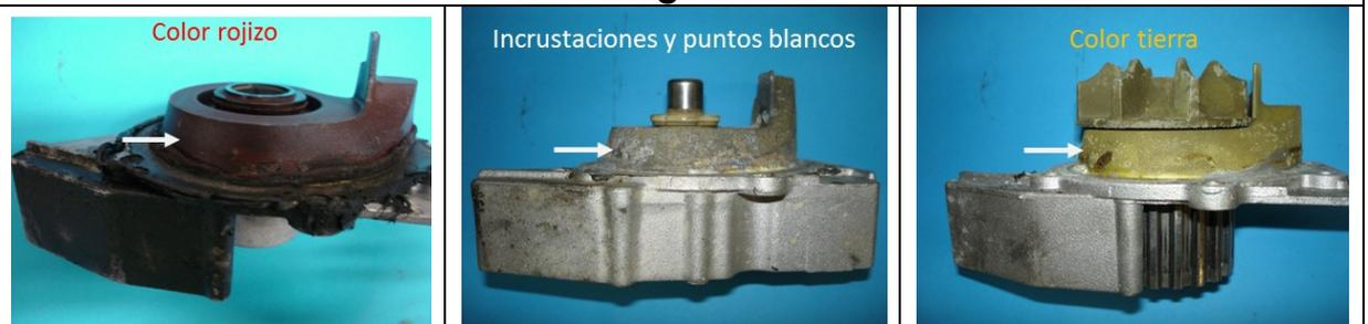
Coloraciones amarillentas, rojizas, puntos blancos, incrustaciones, presencia de óxido blanco o rojo indican la utilización de un líquido refrigerante inadecuado, que rayará las dos caras de contacto del cierre dinámico y provocará la fuga de la bomba de agua
